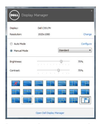
Диалоговое окно быстрой настройки также обеспечивает доступ к расширенному пользовательскому интерфейсу Dell Display Manager, который используется для регулировки основных функций, настройки автоматического режима и доступа к другим функциям.
